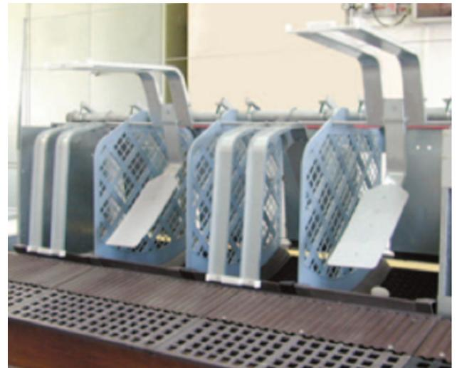
*Illustration 21. Exemple d'un système de pondoirs automatiques avec rampes et mécanismes d'expulsion (photo de MGH)*
