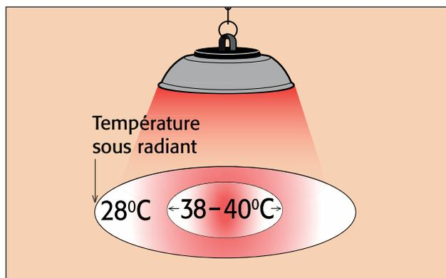
Illustration 7. Température sous radiant
