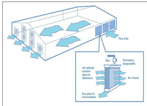
Illustration 42. Système de « pad cooling » avec ventilation tunnel
